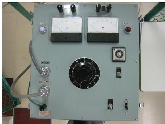
図 1.3: 標準球ギャップによる交流高電圧の測定用装置の操作部
