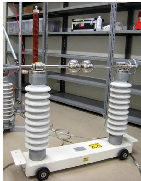
(b) 電圧測定用球ギャップの外観
